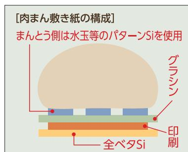
両面塗工が1パスで可能なので、コストダウン&インキが直接食品に触れないメリットが生まれます。
