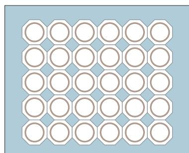
納入形態は巻取りの他、トムソン刃を用いた抜き型を使用し、巻取りを枚葉へと変える加工技術により、枚葉も可能です。
