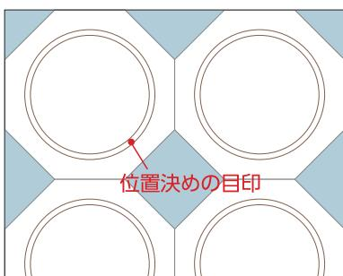
種類を置く位置決めの目印を定位置に印刷し、図柄のずれなく断裁できるので、蒸し上がった製品同士がくっつかず、歩留まりが向上します。
